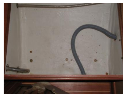
Inspektionshuller foran vandtank
